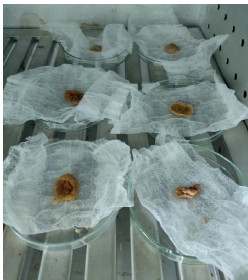
Figura 17 – Retirada da umidade da amostra e do filtro.
