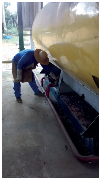
Imagem 02 Trabalhador sem EPIs adequados na Empresa B.(fonte: próprio autor)
