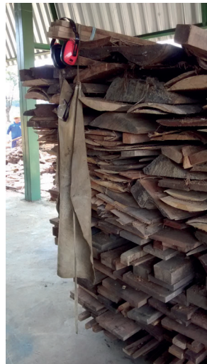
Imagem 04 EPIs acondicionados de maneira incorreta na Empresa B. (fonte: próprio autor)
