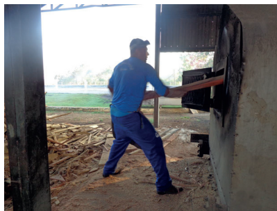
Imagem 01 Trabalhador sem EPIs adequados na Empresa A.(fonte: próprio autor)
