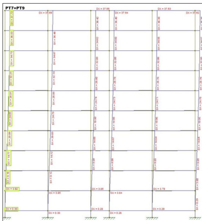
Figura 42:Deslocamentos do Ftool dos pórticos 07 e 09 no eixo X (cargas horizontais totais)
