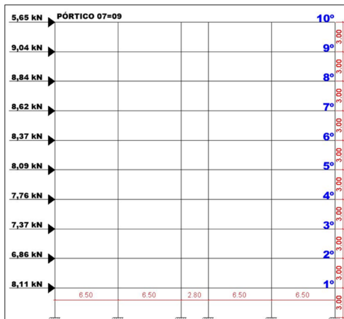
Figura 39: Modelo esquemático de forças horizontais finais do eixo X, pórticos 07 e 09
