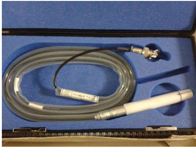
Figura 1: Câmara de Ionização FC65-P utilizada no trabalho.
