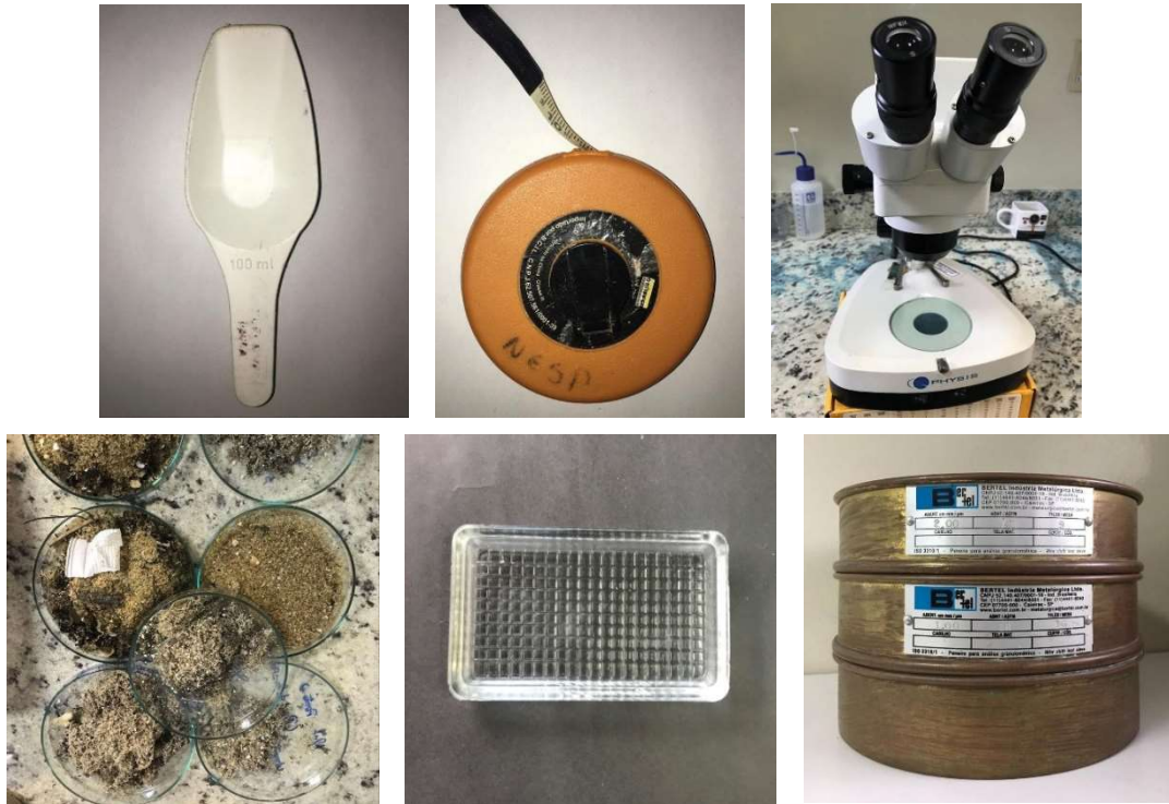
Figura 5: Materiais utilizados na metodologia (pá de 100ml; trena; Estereomicroscópio óptico; Amostras; Placa de Dofffus; Peneiras geológicas)
