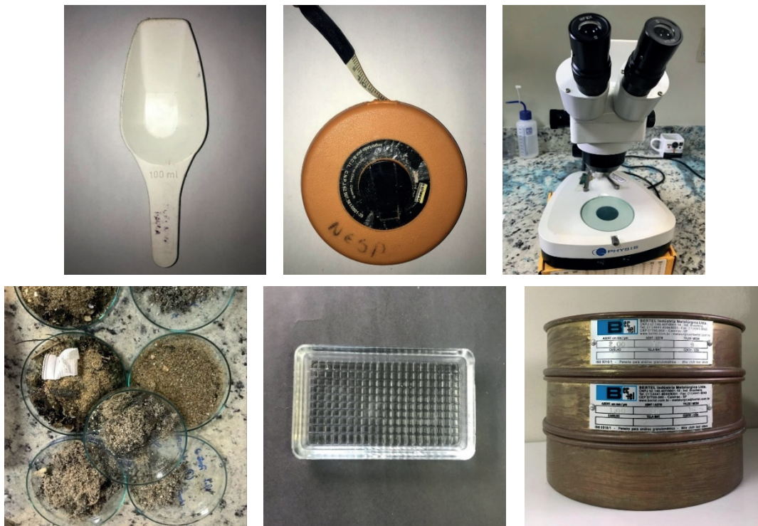
Figura 5: Materiais utilizados na metodologia (pá de 100ml; trena; Estereomicroscópio óptico; Amostras; Placa de Dolfus; Peneiras geológicas)
