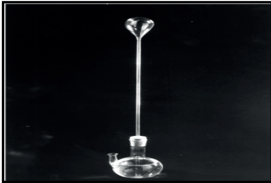
Figura 1. Cópia do termoscópio de Galileu
