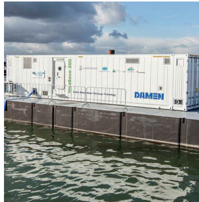
Figura 15 – Sistema de tratamento móvel da Damen Invasave
